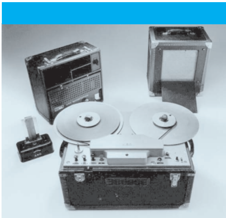
Il Magnetophon AEG (1945), il primo registratore professionale su nastro magnetico
