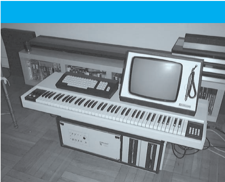
Il Fairlight CMI (Computer Music Instrument) Series II; il primo sintetizzatore digitale/campionatore ad utilizzare la light pen per l'editingto dati
