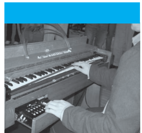
Ondes Martenot. Particolare della tastiera e dei controlli di articolazione sonora
